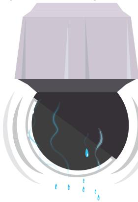
В состав технологии Sharpdome входит уникальная функция Speed Dry, которая помогает получать четкое изображение в дождливую погоду. Кроме того, она упрощает очистку купола, поскольку позволяет использовать более эффективные методы, включая мойку под высоким давлением. Когда функция Speed Dry включена, купол начинает вибрировать с высокой частотой. При этом поверхностное натяжение воды уменьшается, и капли падают вниз.
